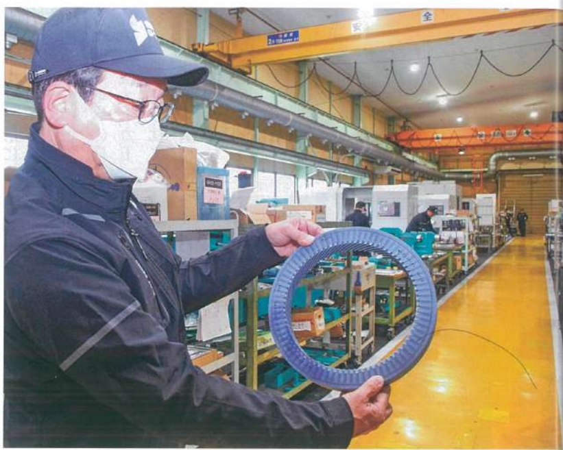
加工機の内部で歯車を研ぐ砥石。なめらかに静かな歯車の回転をかなえる＝出雲市斐川町上直江、清和ジーテック
