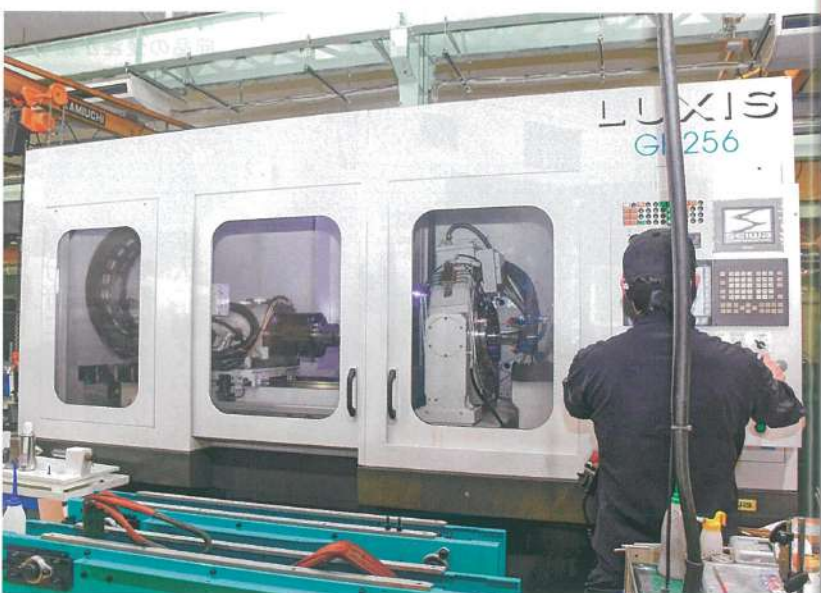
国内トップシェアを誇る清和ジーテックの歯車最終仕上げ加工機
