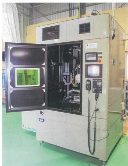
EVバッテリーの加工に使われるアイビーのレーザー加工機
